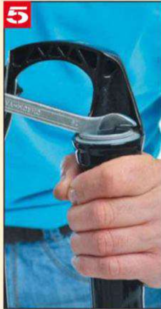
5 Extraire ensuite les joints racleurs et les joints en mousse usagés avec une clé plate de 15.
