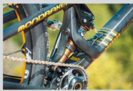
Placé au centre du cadre grâce à un astucieux système de berceau formé par les bielettes, l'amortisseur contribue à abaisser le centre de gravité ce qui favorise le grip en virage. Il est protégé par une large bavette en plastique.
