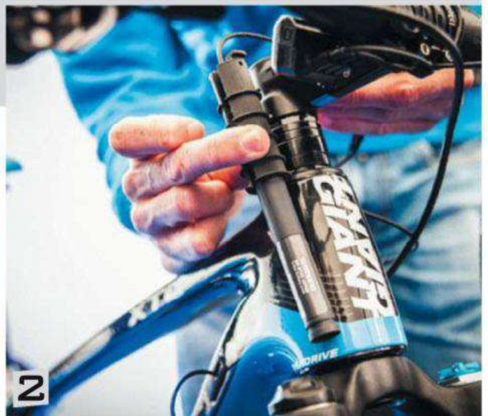
1. Un moniteur affiche le rapport utilisé et le mode sélectionné. 2. La batterie peut se loger dans la colonne de direction ou dans la tige de selle. 3. L'intégration de l'électrique reste discrète. 4. Le logiciel E-Tube, identique à celui utilisé sur la route.
