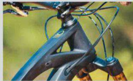
Les renforts du cadre au niveau de la douille de direction laisse pantois d'admiration. Les passages de gaines sont parfaitement intégrés. La potence ultra-courte rend la position moins radicale que sur le Dune.
