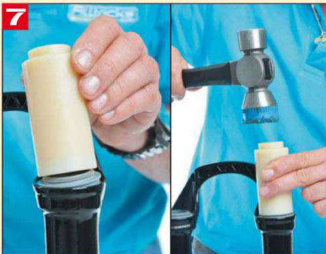
7 Remettre les joints en position, en se servant de l'outil prévu à cet effet, afin de ne pas les abîmer.
