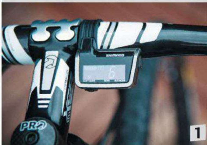
1. Un moniteur affiche le rapport utilisé et le mode sélectionné. 2. La batterie peut se loger dans la colonne de direction ou dans la tige de selle. 3. L'intégration de l'électrique reste discrète. 4. Le logiciel E-Tube, identique à celui utilisé sur la route.
