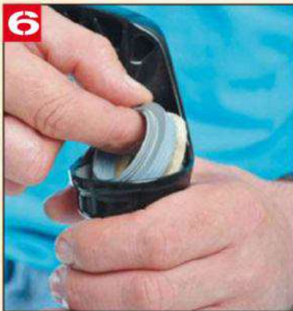
6 Verser un peu d'huile de fourche dans un récipient et faire tremper les joints en mousse neufs afin de bien les imbiber d'huile. Puis les repositionner avec les joints racleurs sur les plongeurs.
