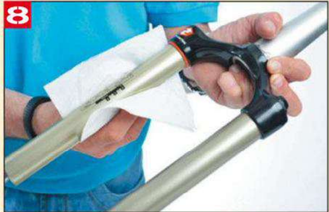
8 Nettoyer avec un dégraissant les plongeurs et l'intérieur des fourreaux.
