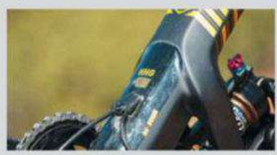
Passage de gaine interne soigné, protège cadre déjà monté sur les fixations ISG05, c'est soigné jusque dans les moindre détails. L'anti-déraillement ne sert à rien avec le mono-plateau XX1.
