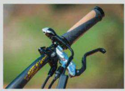
La commande au guidon de blocage des suspensions permet de rouler en descente avec des settings assez souples et de remonter sans craindre le moindre pompage, bien vu ! Les leviers de frein en carbone montrent le soin apporté aux détails...
