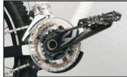
Le pédalier Saint customisé reçoit un Bash SR Suntour retaillé et transparent permettant de mettre en lumière le plateau Renthal et le guide Cydonia.
