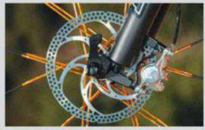
Les étriers Formula T1 pincent des disques de 180mm, un minimum pour un vélo aussi rapide !
