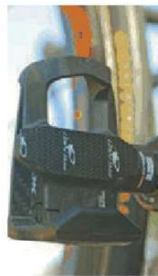
➤ Un bout de ruban de cintre antidérapant en lieu et place de la plaquette Inox sur ces pédales Look Kéo Blade. Le grip, oui. La durabilité? Méfiance.
