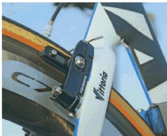
➤ Sur les cadres Propel de la formation Giant-Shimano, les branches Fouriers des freins sont en aluminium. Il s'agit d'une marque suisse spécialisée dans les composants légers.
