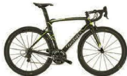
Wilier Cento1 Air 6329 € Cadre: monocoque carbone – Trans: Campagnolo Super Record – Roues: Mavic Cosmic Carbon SLR – Poids: 7,1 kg
