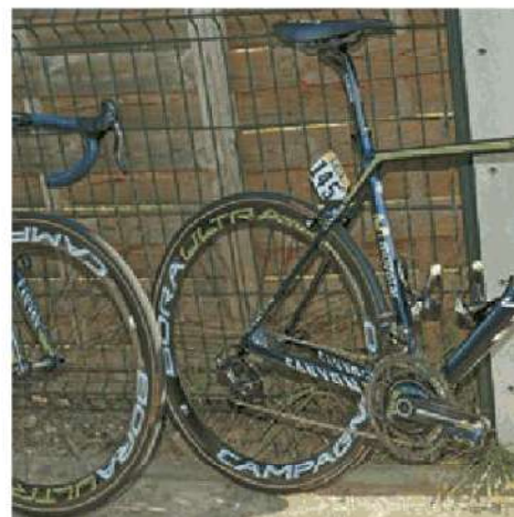
➤ On n'est jamais trop bas! C'est ce que doit penser Lars Bak (Lotto Belisol) qui utilise une potence de piste pour une position encore plus aérodynamique.
