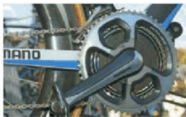
➤ Le capteur de puissance SRM à quatre branches est maintenant disponible et s'intègre totalement dans le groupe Shimano Dura-Ace.
