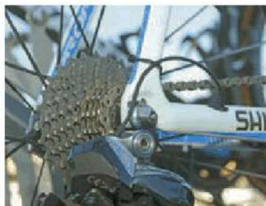
➤ Pour prévenir l'arrachement des fils électriques dans le peloton ou lors d'une chute, les mécaniciens de Giant-Shimano ont placé un collier autour du câble du Di2.
