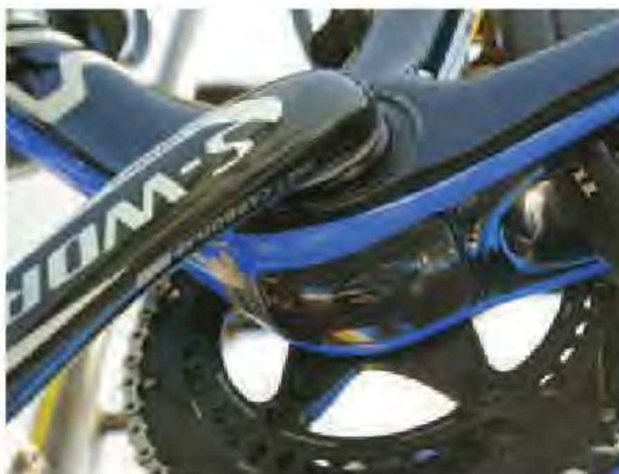
Tout est intégré et, pour fixer la batterie d'un groupe électronique, il faut passer par cette trappe sous le boîtier.
