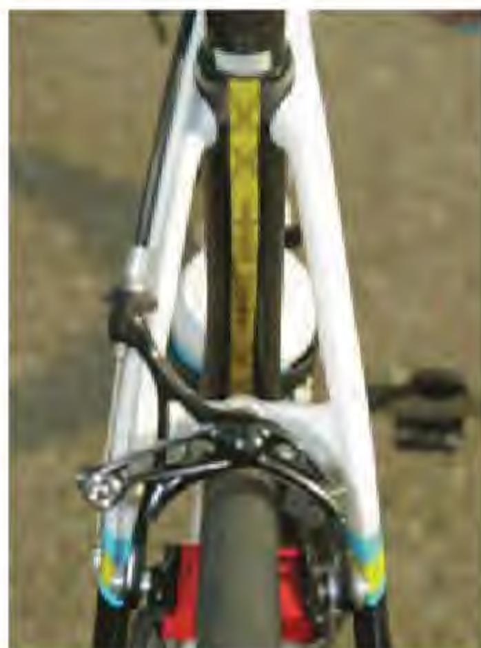
Le tube de selle est fin. Les haubans, eux, sont écartés et donnent un air rétro au vélo.
