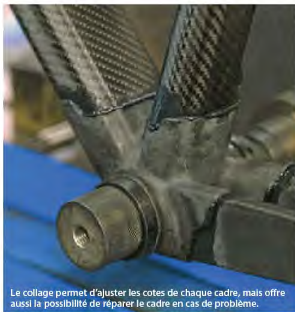
La boîte de pédaler comporte deux cuvettes vissées qui portent les roulements internes.
