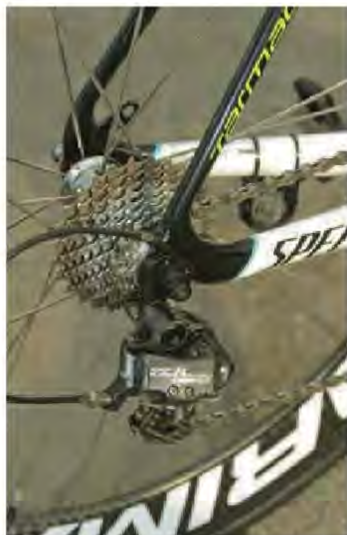
La sortie de câble est très réussie. Elle est prévue pour les transmissions mécanique et électronique.
