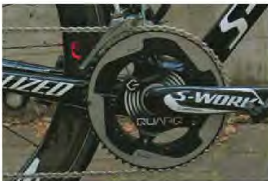
Plateaux Sram et capteur de puissance Quarq prennent place sur le pédalier S-Works Fact Carbon. Un montage non commercialisé pour l'équipe Omega Pharma-Quick Step.
