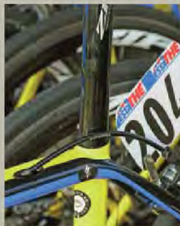
Côté gauche, sous la pastille autocollante Specialized, se trouve le serrage de la tige de selle. Celle-ci reste en alu pour alourdir le vélo du Team Tinkoff-Saxo.
